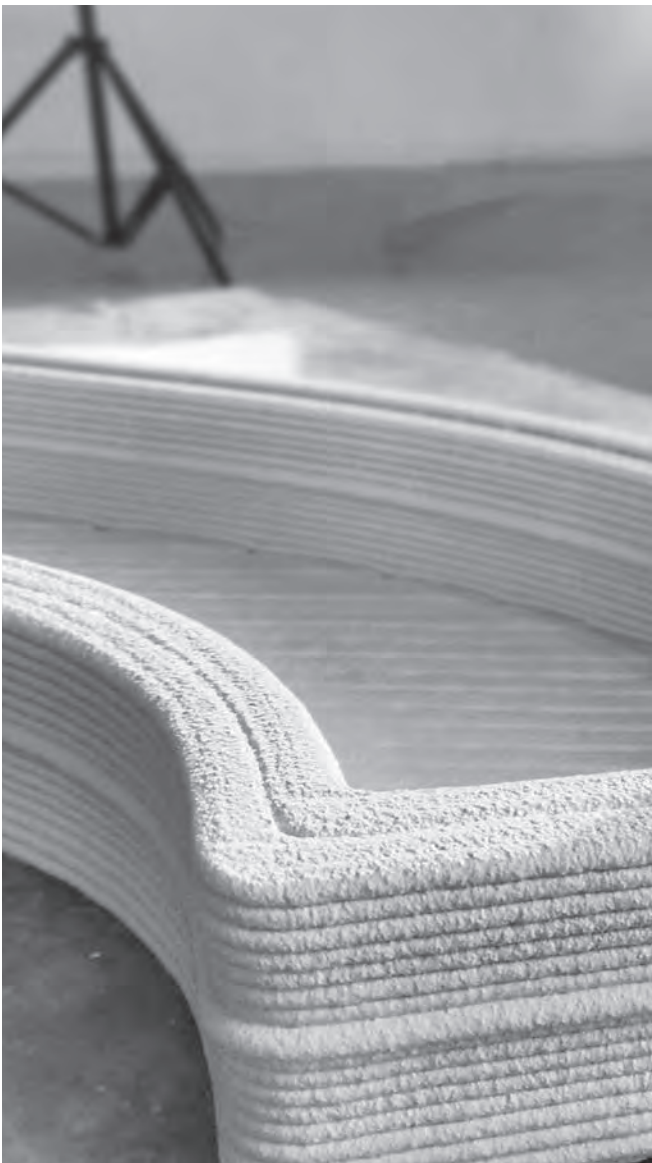
Mobiler 3D-Drucker zur additiven Erzeugung von Pflastersteinen (Quelle: PrintStones)
