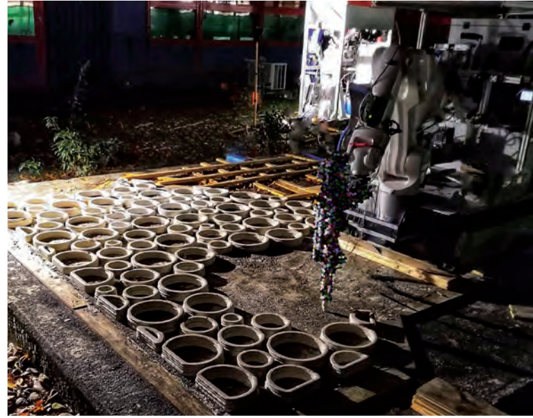
Mobiler 3D-Drucker zur additiven Erzeugung von Pflastersteinen (Quelle: PrintStones)
