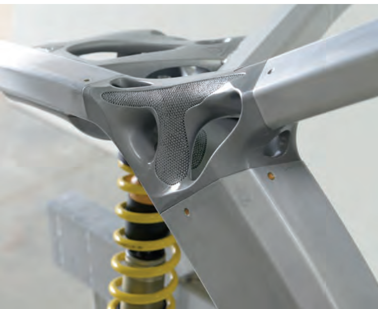
NextGenSpaceframe 2.0: Additiv gefertigter Knoten in Kombination mit Strangprofilen (Quelle: EDAG Engineering GmbH)
