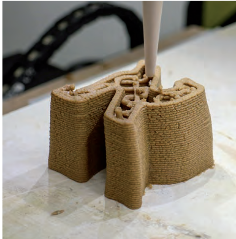
Sanddruck mit Chitosan und Zellulose als Bindemittel (Quelle: Filipe Natalio)
