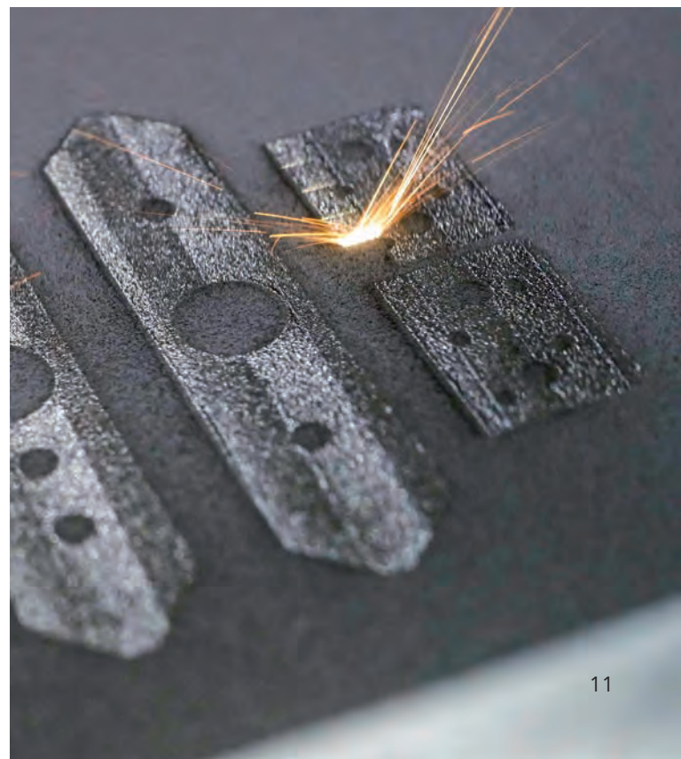
Belichtungsprozess beim Laserstrahlschmelzen (Quelle: Protiq)
