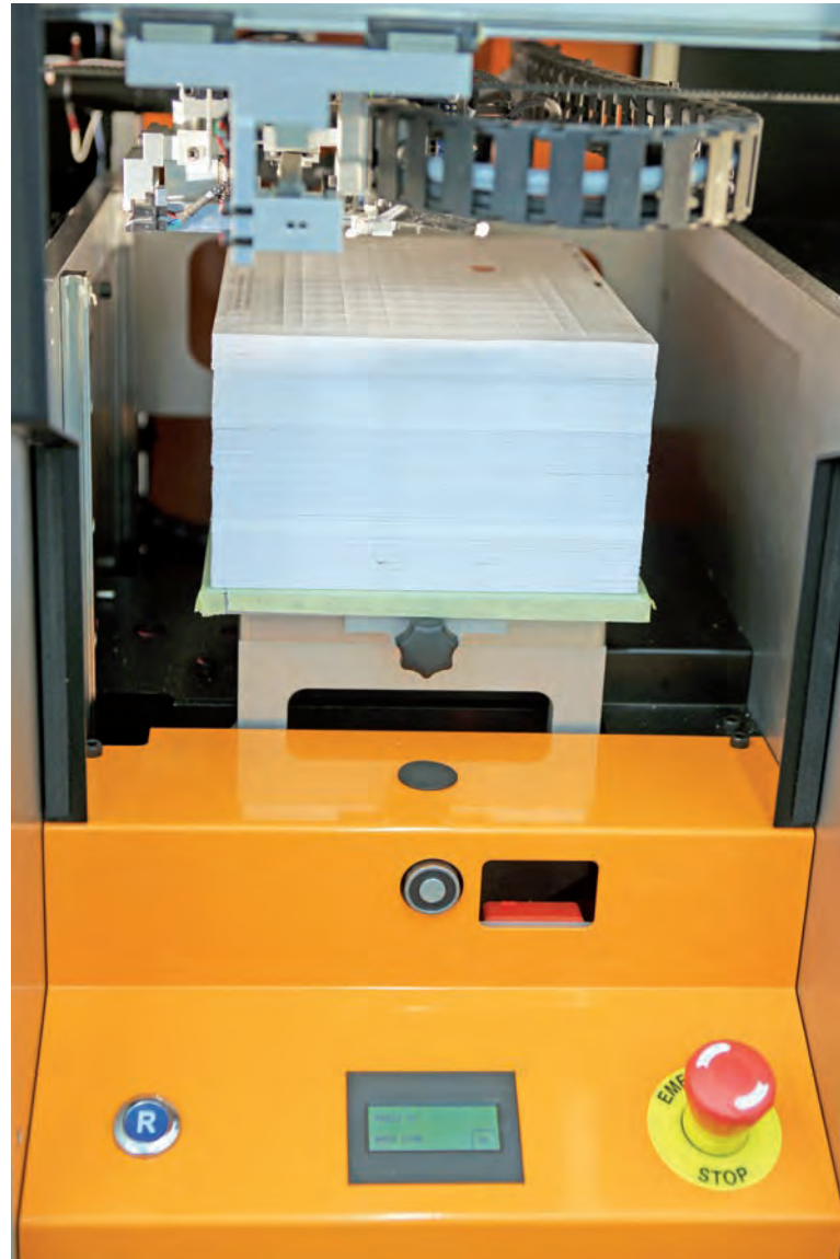
Bauraum einer MCor-Anlage nach dem Schichtlaminat-Verfahren (Quelle: 3D-Picture, Foto: Dieter Bielert)
